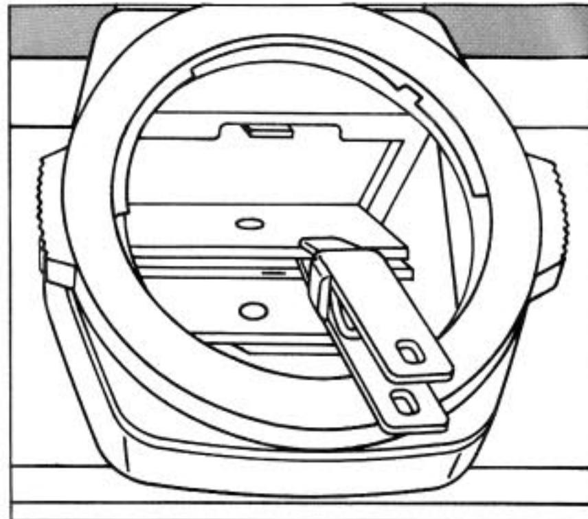
J 枠内のフォーカシングスクリーンの突起部を、付属のピンセットで持って静かに引き、フォーカシングスクリーンを取りだします。
