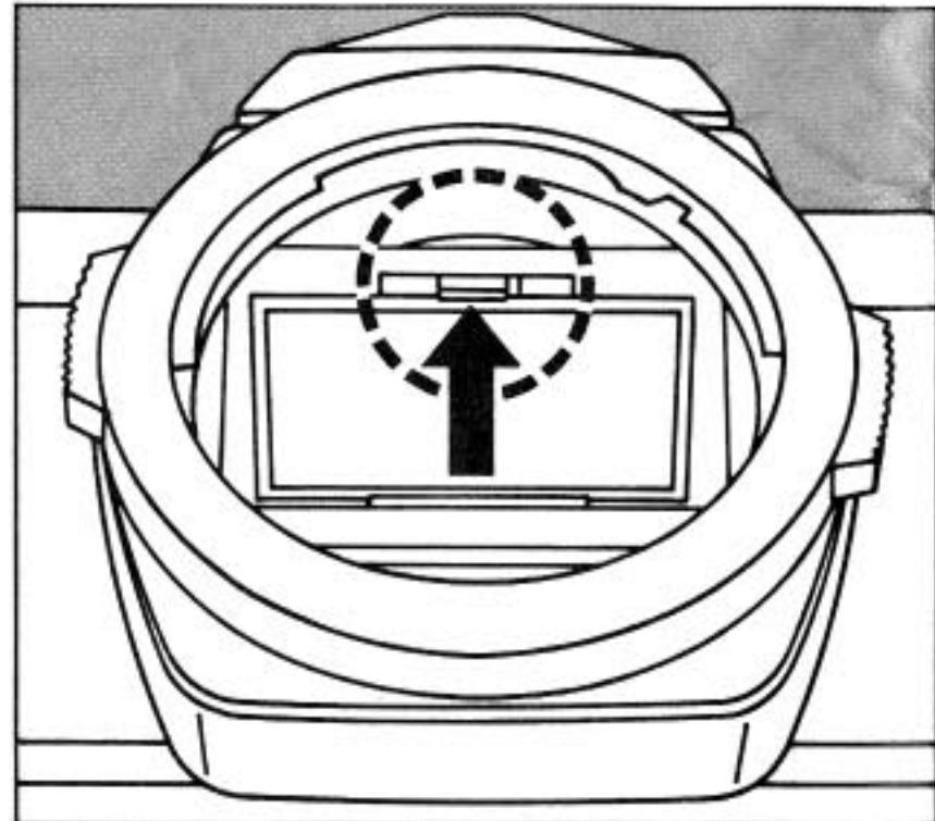
J カメラボディからレンズを取りはずし、ボディマウント内部上方にあるツメを手前に引き、フォーカシングスクリーンを下げます。
