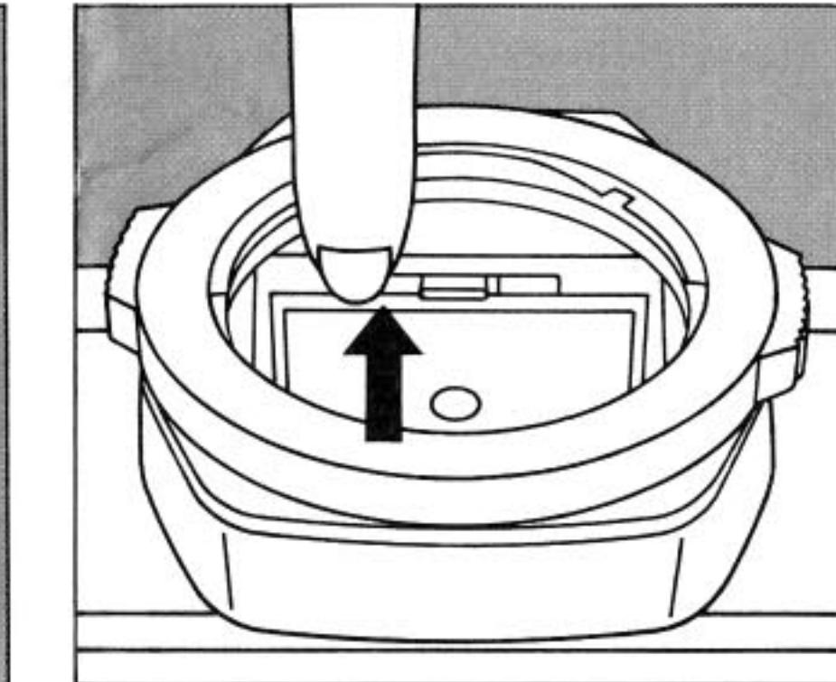
J 新しいフォーカシングスクリーンをピンセットで持ち、枠の中に入れ、枠を押しあげてカチリと音がするまで静かに押込みます。その時、スクリーンやミラーに触らないように注意してください。
