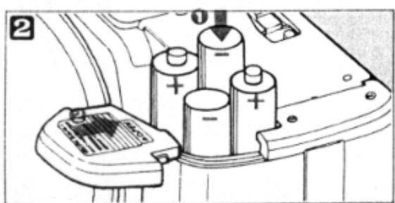
電池の向きを正しく合わせて入れ、電池ぶたを閉めます。
